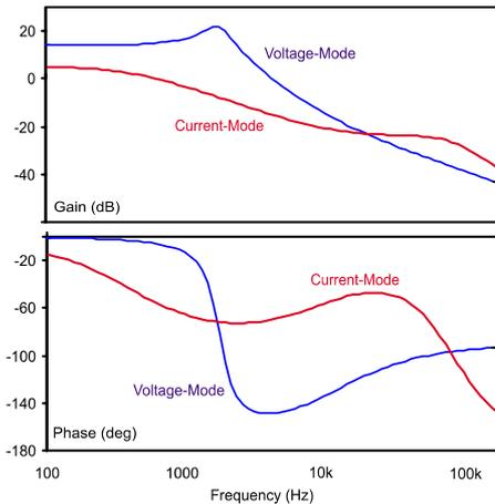
Fig. 3: Voltage-Mode/Current-Mode Comparison
